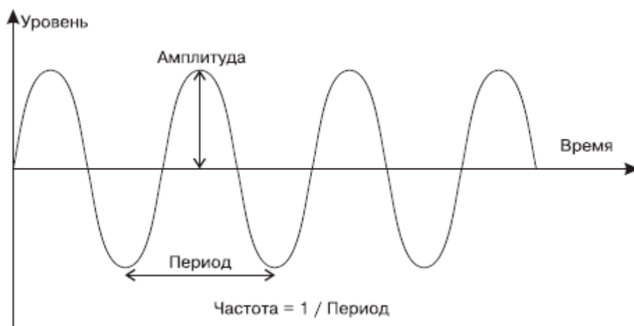
Рис. 1.3. Синусоида – график звуковых колебаний
