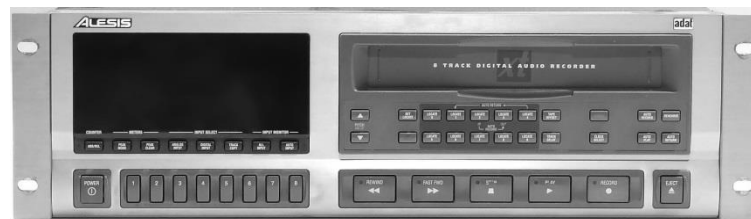
Рис. 2. (англ. Alesis Digital Audio Tape) – цифровой магнитофон, получивший широкое распространение в практике студийной звукозаписи в 1990-е годы.
