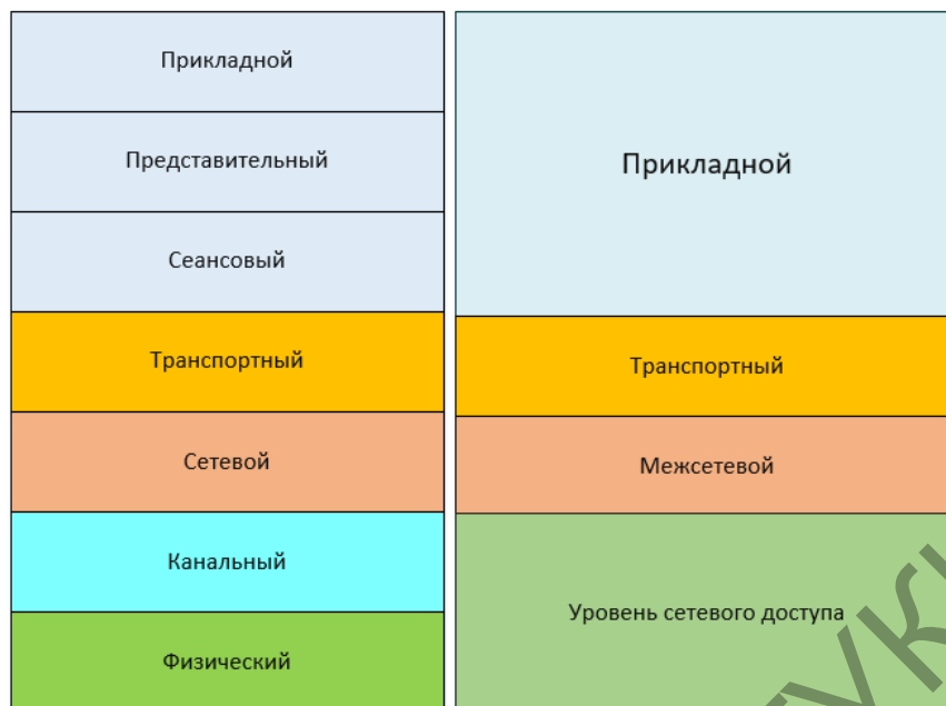
Рис. 9.4 – Модели OSI и TCP/IP
