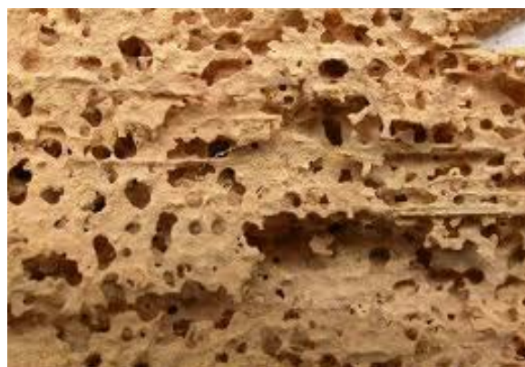
Малюнак 3.3.5 – Разбураная мэблявым тачыльшчыкам дошка абраза.
